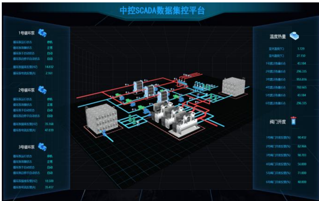
图 1 中控 SCADA 软件界面截图
